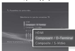
Si vous sélectionnez [HDMI], vous aurez l'option de choisir [Automatique] ou [Personnalisé] sur l'écran suivant. Dans la plupart des cas, sélectionnez [Automatique], et les paramètres de sortie vidéo seront définis automatiquement.
