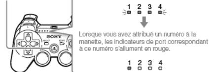
Vous pouvez raccorder jusqu'à 7 manettes simultanément. Le numéro de la manette est indiqué par le chiffre situé au-dessus des indicateurs de port. Pour les numéros 5 à 7, additionnez les chiffres des indicateurs de port allumés.
