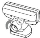
Alignez le repère d'angle d'objectif sur l'indicateur bleu d'angle d'objectif.
